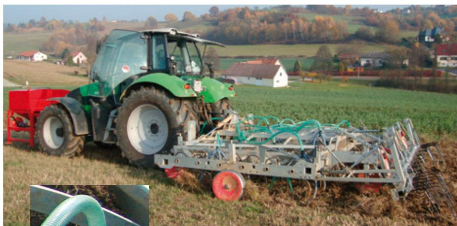
Avec ses 6 roues de terrage réglables par manivelle ce vibroculteur est aussi disponible en largeurs de 3 m ; 3,5 m ; 5,5 m et 6,25 m (60 dents et 60 descentes de semis).
