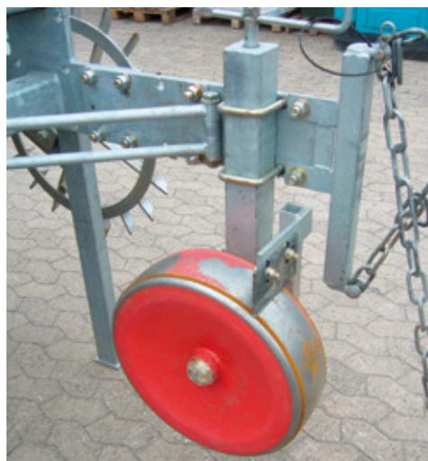
**Roues de terrage** : les deux roues de terrage arrières peuvent être remplacées par un rouleau émietteur
