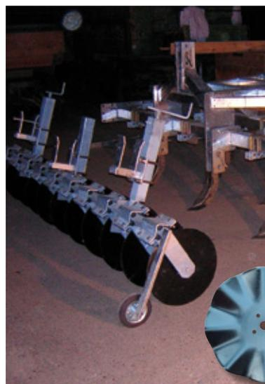
**Rouleau à disques** qui se monte sur la première poutre (utilisé en semis direct et en cas de gros risques de bourrage)
