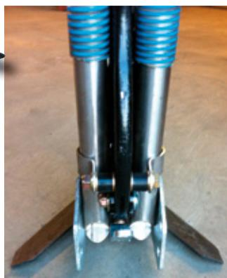
Configuration pour semer des céréales derrière des pattes d'oie de 36 cm (dernière destruction de repousses et d'adventices au moment du semis). La dent est équipée de deux descentes de semis en inox et de déflecteurs étroits (bandes de 12 à 15 cm) ou larges (semis en réparti)
