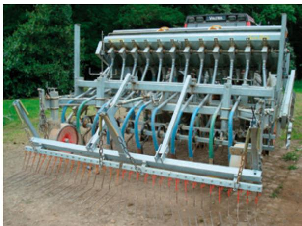
**Semoir avec 3 trémies** à 12 sorties chacune : 2 trémies principales et une trémie auxiliaire pour petites graines. Une des trémies peut servir pour la fertilisation localisée.
