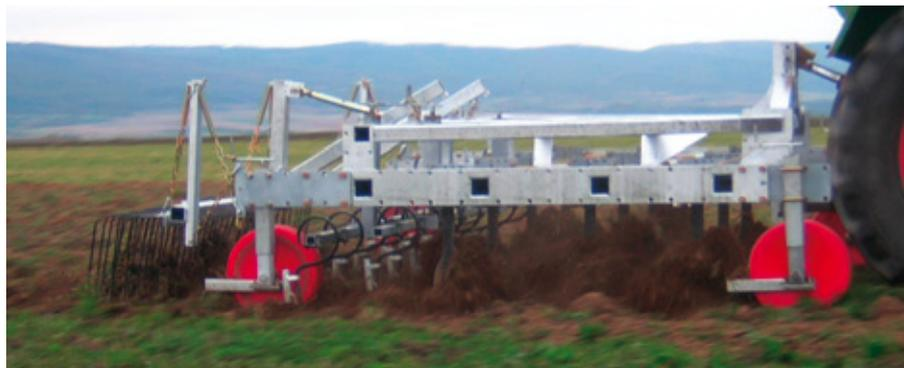
**Outil de travail du sol** : configuration 3m avec 4 poutres de 100 x 100, 10 attaches dent, 10 dents forgées, 4 roues de terrage, une herse paille et 2 rangées de dents vibro. Les dents forgées ainsi que les dents vibro sont réglables en hauteur et en angle de travail. Cet outil polyvalent, développé en collaboration avec Manfred Wenz et son fils, peut être équipé d'un semoir. Il existe également pour des largeurs de travail de 1,8m, 2,4m et 3,5m.
