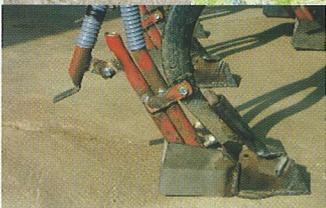
dent est réglable en hauteur et même en inclinaison en fonction du travail recherché grâce à une broche et un système de trous.
