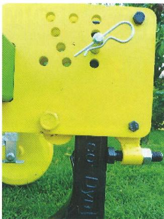
Outre l'angle d'attaque et sa forme en col-de-cygne afin de faciliter le scalpage sans trop brasser le sol, l'originalité de la dent Eco-Dyn est dans son mode de fixation qui permet de modifier facilement l'angle et la profondeur de travail de chaque élément indépendamment des autres. Ce concept a été développé pour permettre de semer des associations en positionnant les graines à des profondeurs différentes.
