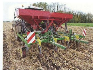
Machine en version strip-till avec l'installation de couvert derrière un maïs récolté en épis suivi d'un broyage des tiges et un léger mulchage. Le séchage en cribs comme le pratique M. Roesch lui permet, outre les économies de séchage, de sortir le maïs 3 semaines à un mois plus tôt, dans de meilleures conditions avec la possibilité d'implanter un couvert plus rapidement.
